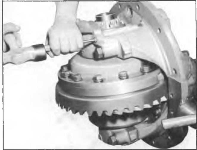
Fig. 4J--Removing Shifter Yoke Shaft
