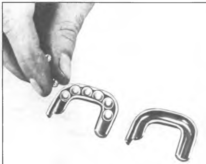
Fig. 12--Filling Ball Guides
